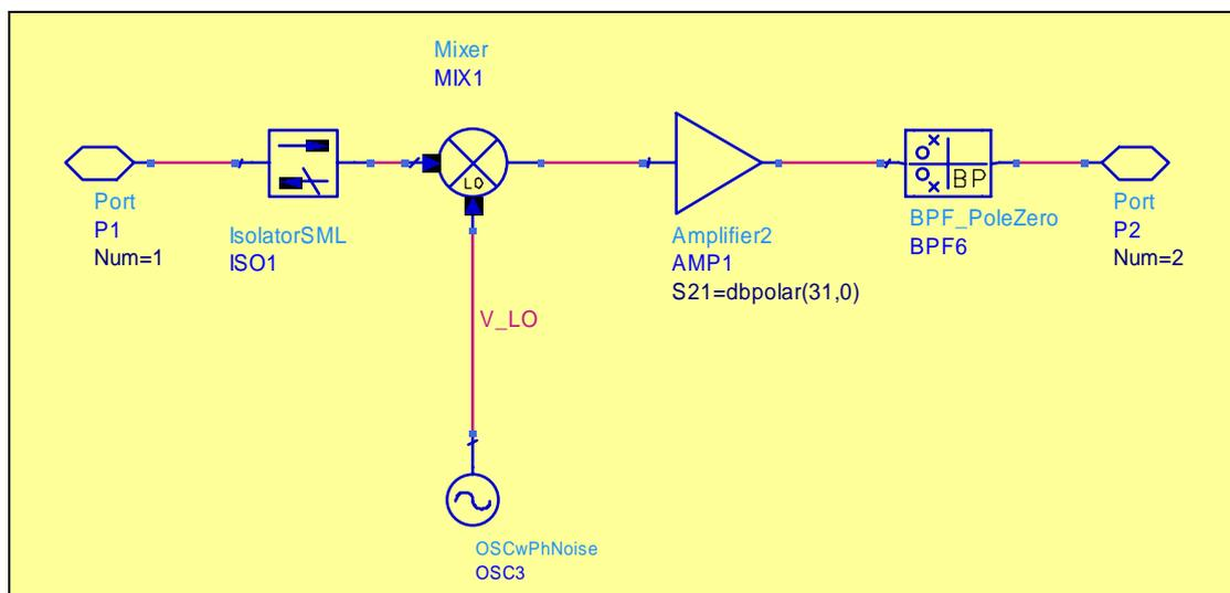
Figure 3 The 1<sup>st</sup> down conversion module
