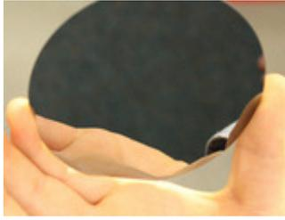
Figure 6. A silicon wafer etalon.
